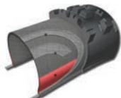
**Double Down** - Doubledown Reifen sind aufgebaut wie unsere Downhillreifen: zwei Karkassenlagen verstärkt mit einer Butyleinlage in der Seitenwand. Durch zwei 120 TPI (statt 60TPI) Karkassenlagen und Aramidwulst sind sie aber deutlich leichter als unsere Downhillreifen, deutlich stabiler und robuster als unsere TR + EXO Reifen und somit ideal für harte Enduro Kurse.
