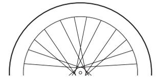
Das **R50** ist unser High Performance Aero-Laufrad. Mit 50 mm Felgenhöhe, 19 mm Innenbreite und Tubeless-Kompatibilität bietet es alles, was du brauchst, um so richtig Gas zu geben: Leichtes Gewicht, gute Aerodynamik und hohe Steifigkeit – und es ist speziell auf die Powershift-Nabe ausgelegt.
