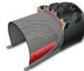
**Butylgummieinlage** - Eine zusätzliche Butylgummischicht in der Seitenwand der Downhillreifen, die Durchschläge verhindert und die Felge schützt.
