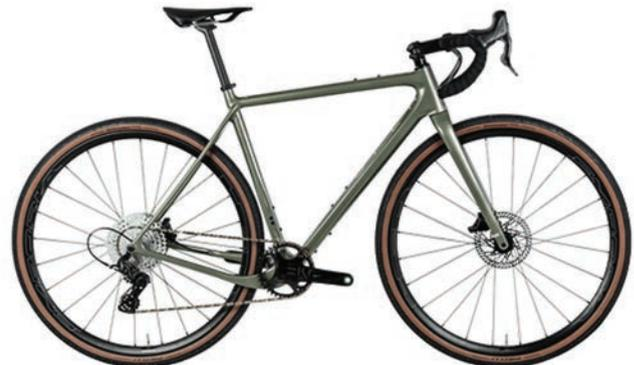
Der perfekte Einstieg ins Gravel-Fahren, kombiniert mit dem legendären U.P. Rahmen mit der vielseitigsten Gravelgruppe auf dem Markt; Campagnolo Ekar 1x13. Es wird mit einer 13-Gang-Kassette mit 9-42 Zähnen, einem 38-Zähne-Kettenblatt passend zum 9-Zähne-Startritzel, Ergopower-Bremshebeln und 160-mm-Flatmount-Bremsen geliefert.
