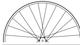
Die brandneuen **G19** basieren auf einer leichten, hakenlosen Carbonfelge mit niedrigem Profil, 25 mm Innenbreite und 19 mm Felgenhöhe. Er ist bereits für Powershift vorbereitet und Tubelessfähig. Ein nachgiebiges, leistungsorientiertes Laufrad, das auch auf abenteuerlichen Fahrten hohen Komfort garantiert.
